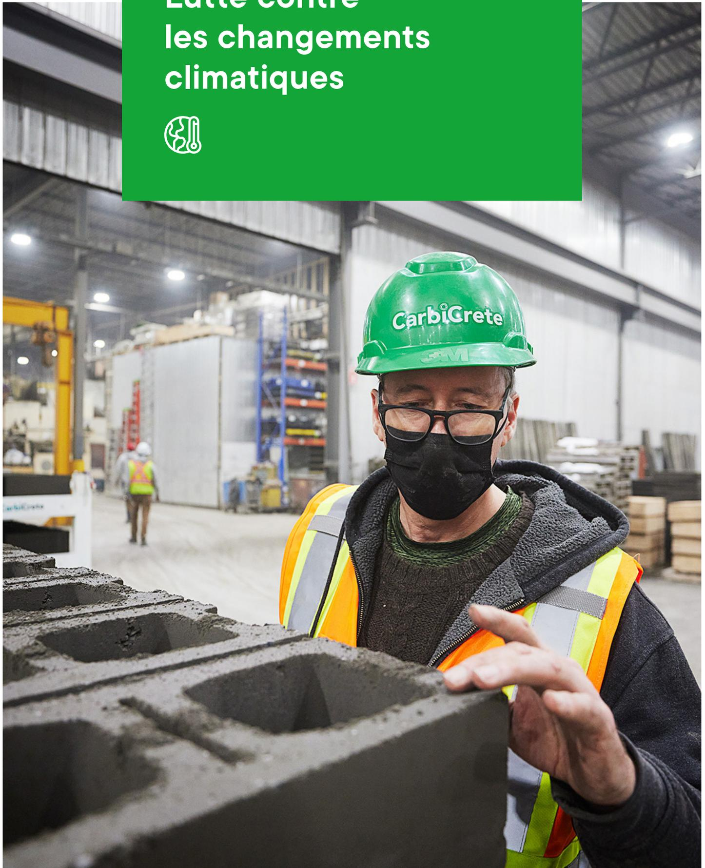
► CarbiCrete a conçu un béton sans ciment, une innovation lui permettant de mettre en marché les premiers blocs de béton négatifs en carbone en Amérique du Nord. La réduction du volume d'eau utilisé et des contaminants liés aux intrants conventionnels en sont d'autres bénéfices.
